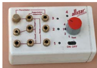
(Foto Fa. allstar) Werkstatttester mit Microunterbrechung
